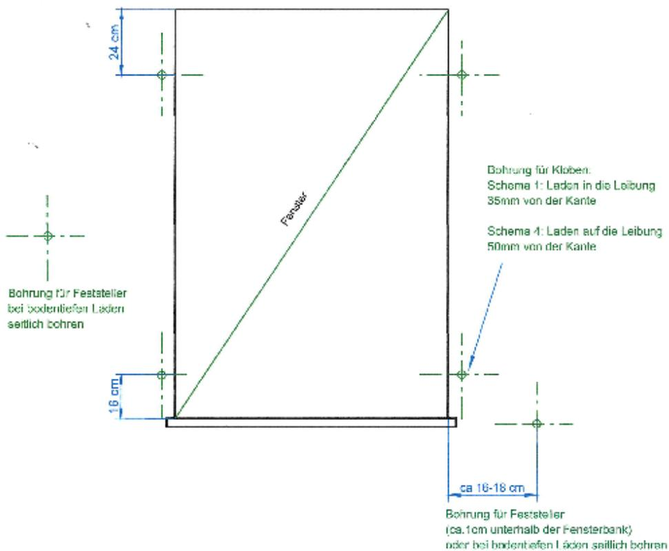
Für Montage Schema 1: ca 35 mm von der Leibungskante bis Mitte Bohrung
