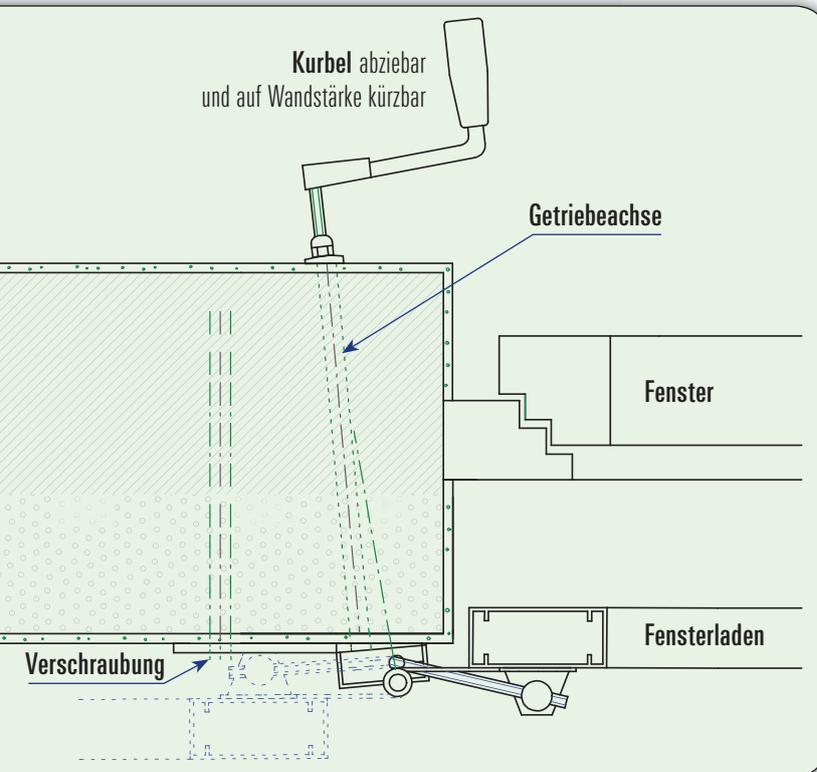
Die Getriebeachse wird mit 5° Schräge durch das Mauerwerk gebohrt.
