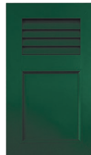
AJB • 1/3 feste Jalousie 2/3 Blechfüllung mit Querfries. Lamellenstärke 38/50mm
