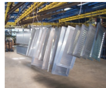
AJB • 1/3 feste Jalousie 2/3 Blechfüllung mit Querfries. Lamellenstärke 38/50mm
