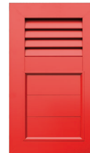
AJR • 1/3 feste Jalousie 2/3 geschlossene Paneelfüllung mit Querfries. Lamellenstärke 38/50mm
